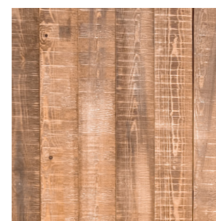
自然塗料による塗装（単色塗り）
